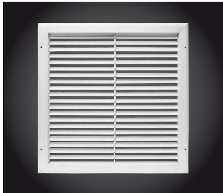
Por medio del ajuste individual de paletas con base de suspensión, las rejillas "AEROMETAL", obtienen variables condiciones de deflexión para satisfacer todas las demandas de distribución del aire. Para obtener tiros largos y flujos de aire estrechos utilice ángulos de  $0^\circ$  a  $22\frac{1}{2}^\circ$  de deflexión; para tiros cortos y flujos mas anchos usarlas paletas de  $45^\circ$  o más.
