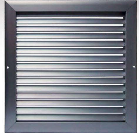
El marco y las hojas son de aluminio extruido con acabado anodizado. El marco tiene un espesor típico de .050", y está separada de las hojas por una pista de extrusión de PVC rígido que se convierte en parte integral de la estructura. Este método de montaje elimina la corrosión y la vibración. Los agujeros del marco de montaje son hoyuelos, que permiten el uso de tornillos de cabeza avellanada.
